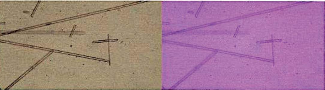
Fibra observada bajo microscopio de luz polarizada (PLM), aumento
